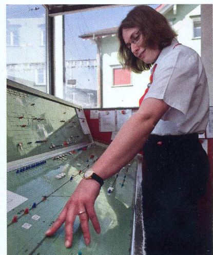
Elektromechanisches Stellwerk in Basel-Rheinhafen, bis 2017 in Betrieb (links), Bedientisch eines Gleisbild-Relaisstellwerks: Mit dem gleichzeitigen Drücken der Tasten am Anfang und Ende der Fahrstraße wird diese eingestellt und gesichert.
