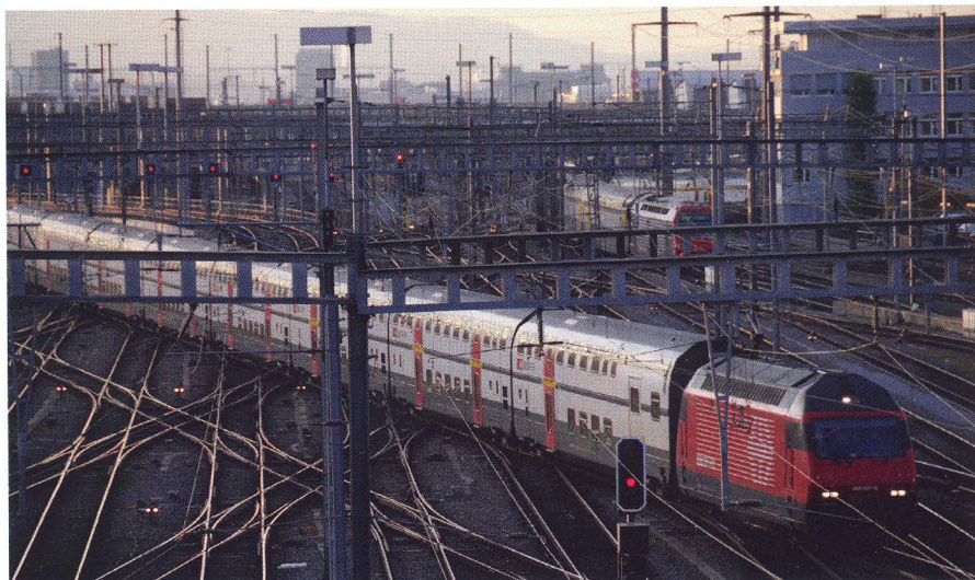
Ein Zug überquert das ganze Gleisvorfeld des Hauptbahnhofs Zürich (Blick mit dem Bahnhof im Rücken Richtung Westen; 2010). Nur dieser IC 2000 Doppelstockzug hat freie Fahrt, über allen andern Gleisen gebieten auf Rot gestellte Signale Halt. Fotos: Johannes von Arx
