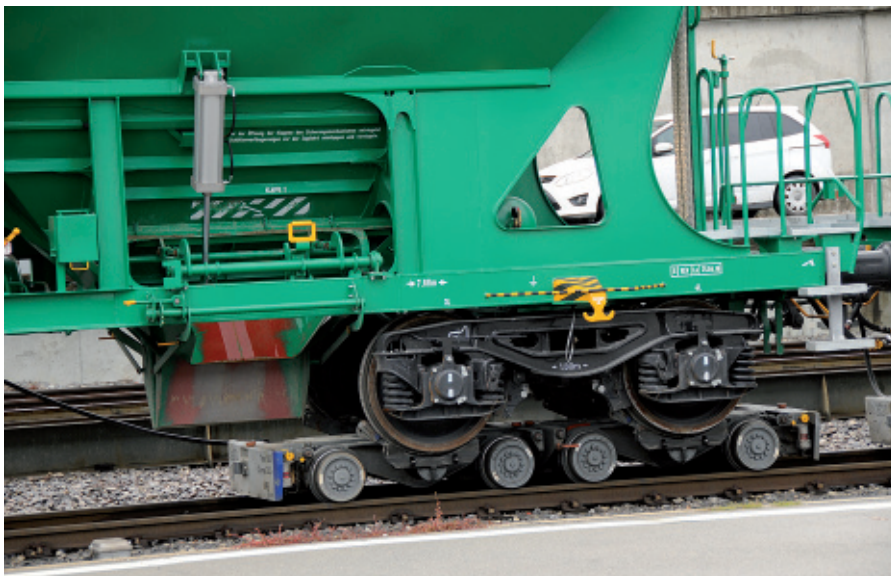
Ein Güterwagen – zwei Spuren. Hier von Morges am Genfersee in den hügeligen Jura hinauf war Meterspur zwingend. Für die Interoperabilität sorgt ein Hilfsdrehgestell (Diplory).
