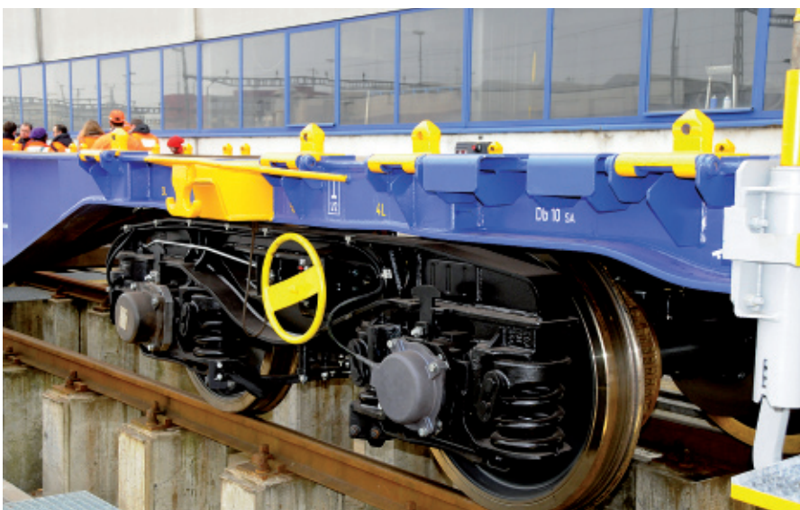
Lange blieb die Technik bei den Güterwagen stecken. Seit Anfang 2017 testet SBB Cargo an 16 Wagen ganz verschiedene Komponenten, welche die Bahnindustrie zur Verfügung stellt. Beispielsweise automatische Kupplungen, Scheibenbremsen, radial einstellbare Drehgestelle, Tracking, Temperaturüberwachung usw.
