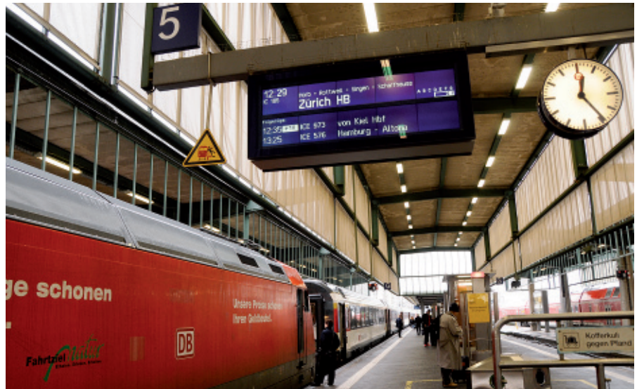
Gebremste Interoperabilität: Der IC 185 verlässt den Hauptbahnhof Stuttgart. Zwei Stunden später muss in Singen für die restliche Strecke nach Zürich die Lokomotive gewechselt werden: Andere Zickzackbreite der Fahrleitung, unterschiedliche Sicherungssysteme usw.
